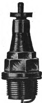
SPARK PLUG WITH A. L. A. M. STANDARD THREAD.
